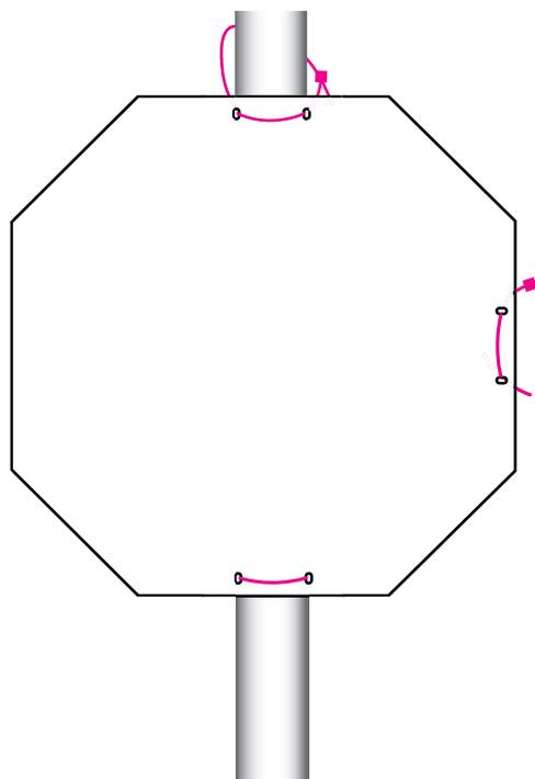
4. Kabelbinder durch die seitlichen Stanzlöcher führen, festziehen und die Enden kürzen. Achtung - um die Stabilität des Plakates zu gewährleisten bitte **ALLE** Kabelbinder anbringen.
